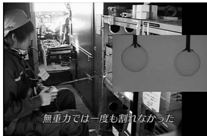
図1 航空機を利用した無重量実験。シャボン玉の寿命が無重力になるとなぜ延びるかを学生が調べた。(NHK「アインシュタインの眼」より)
