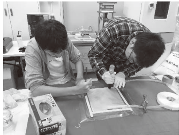
VaRTM法において真空漏れがないか確認する様子
