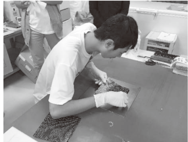
炭素繊維のクロスを重ねる様子
